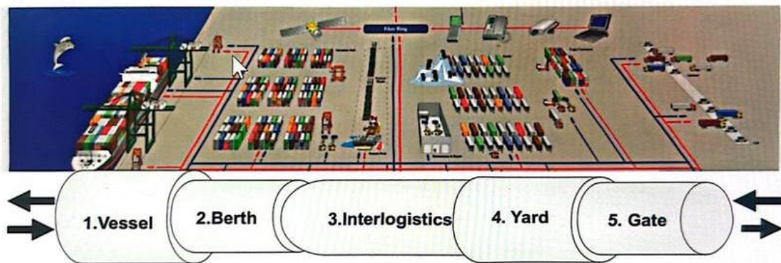
Figure 7: Représentation schématique des principales opérations gérées par un Terminal Operating System (TOS) dans un terminal à conteneurs.
