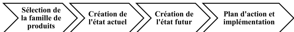
Figure N°8 : Les étapes de la construction de la VSM
