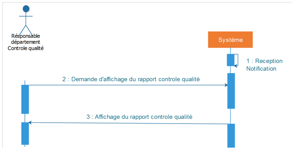
Figure 33 Diagramme de séquence « consulter le rapport contrôle
