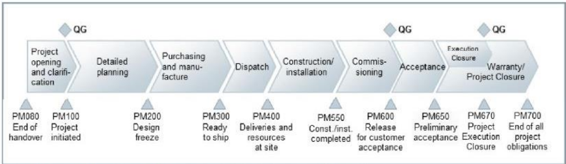
Figure 2-8 : processus de la phase exécution.
