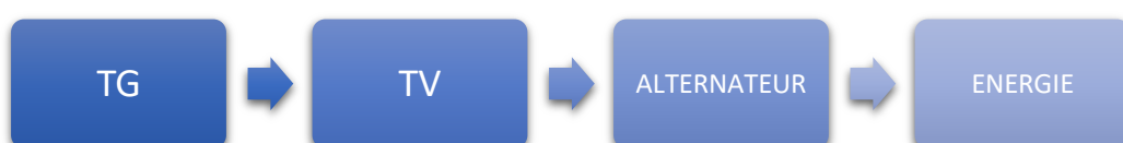
Figure N°11 : production d'énergie avec cycle combiné (single SHAFT)
