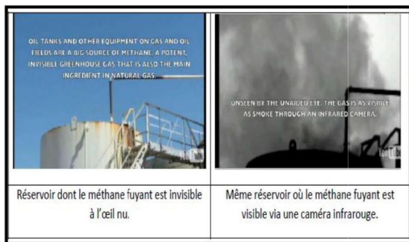
Figure 13: La quantité de méthane fuyant les réservoirs visibles via une caméra infrarouge
