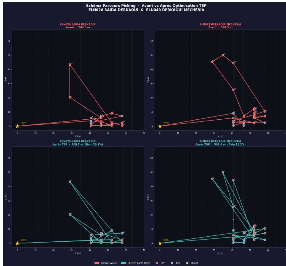
Figure 25 : le schéma des parcours picking avant et après optimisation pour ELN026 et ELN049
