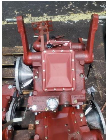
Figure 34 : installation hydraulique complète.
