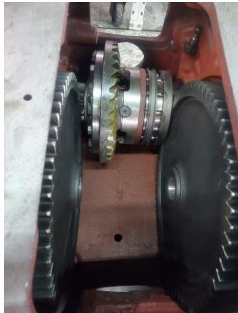
Figure 28 : montage des grandes roues.
