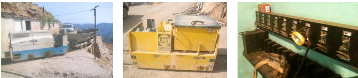
Figure 14: Chargeur des Lampes, Loco tracteur (électrique), et Loco tracteur (diésel)
