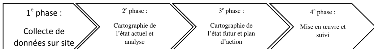
Figure 06 : les phases de réalisation d'une VSM
