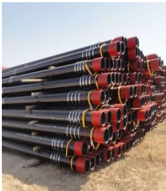
Tubage de puit Pétrolière
