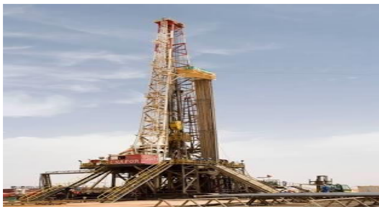
Appareil de Forage
